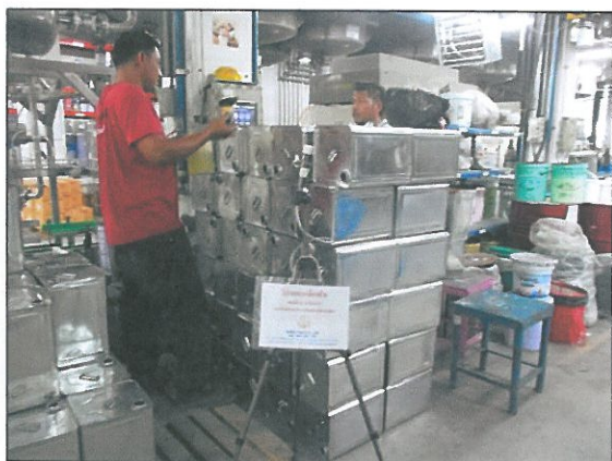
อาคารผลิต ชั้น 1 : แผนกทินเนอร์ ตรวจวัด Methanol และ Toluene
