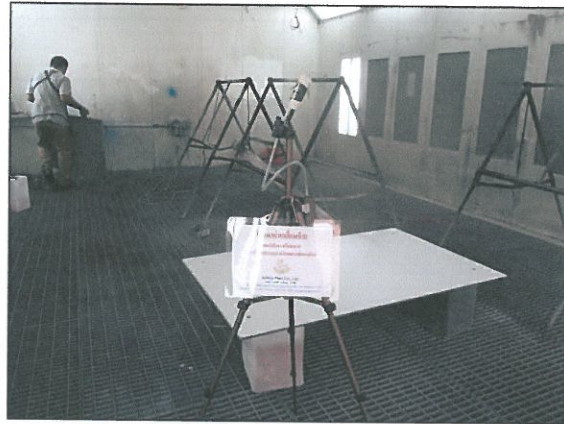
คลังสินค้า ชั้น 1 : ห้องพ่นสี ตรวจวัด Methanol และ Xylene
